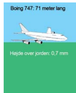
Figur 24. Læse-/skrivehovedet (venstre) bevæger sig med mere end 300 km/t og en afstand på 5 nm henover harddiskens overflade, mens det enten aflæser eller ændrer magnetiseringen af de bitte-små områder på overfladen. Det svarer til, at en 74 meter lang jumbojet flyver i en højde på kun 0,7 mm over jorden.
