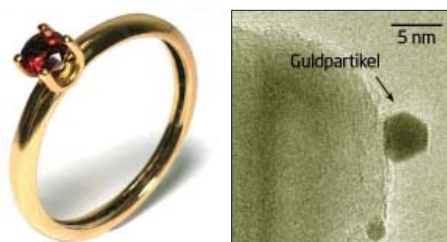
Figur 1. Smykker af guld er ufarlige, fordi guld er et ædelmetal og derfor inaktivt. Guldpartikler i nanostørrelse (højre) har overraskende vist sig at være meget reaktive og egner sig derfor vældigt godt som katalysatorer. Det er dog uvist, om partiklernes reaktivitet er farlig for mennesker og dyr.
