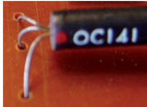
Figur 2. DASK brugte store 'radiorør' (venstre), som i GIER blev erstattet med de meget mindre transistorer (0,5 cm) (højre). Bemærk de tre ben på transistoren, som er metalelektroderne.
