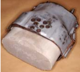
Figur 7. Bilkatalysatorer indeholder nanopartikler af platin, der renser udstødningsskassen for skadelige nitrogenforbindelser. Partiklerne kan imidlertid slides af katalysatormaterialet og slippe ud i miljøet.
