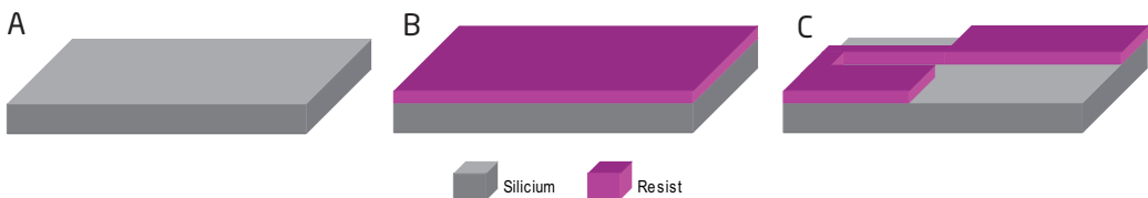
Figur 10. A. Siliciumskive uden, B. med resist og C. siliciumskive med resterende resist. Med en elektronstråle har vi tegnet vores mønster, hvorefter resisten i det pågældende område er blevet opløst og vasket af.
