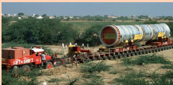
Figur 4. En kemisk reaktor fra Haldor Topsøe på vej til et ammoniak anlæg i Indien.
