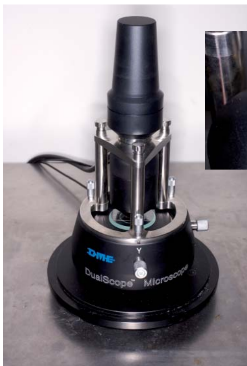
Figur 16. Atomic Force Mikroskop. Prøven lægges ned i midten af apparatet. Billedet øverst til højre viser mikroskopet vendt om – nålen (ikke synlig) befinder sig for enden af en lille siliciumbjælke, der er monteret i midten
