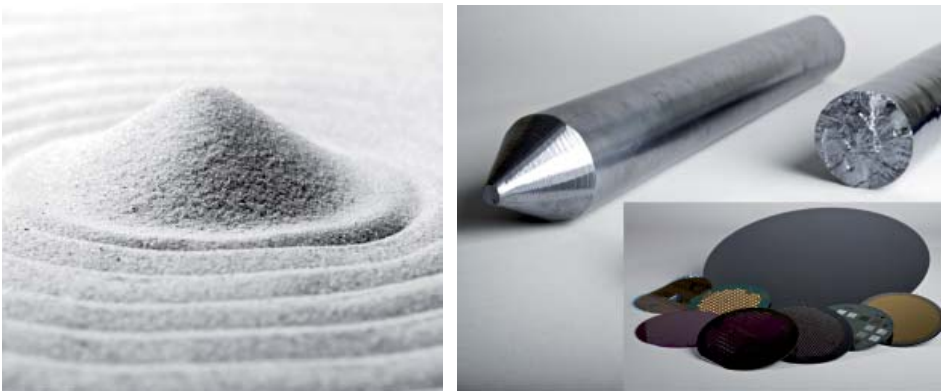
Figur 18. Silicium: fra sand til skive. Sand ( \text{SiO}_2 ) (venstre) smeltes og bearbejdes til lange krystaller, der efterfølgende skæres i tynde skiver på ca. 0,2-0,3 millimeter (højre).
